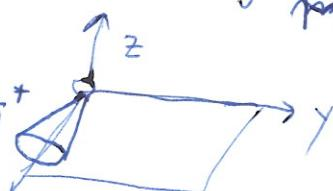
$$2. \text{ Zasuk za } \varphi \text{ okrog } \hat{z}: \vec{r}_T'' = \begin{pmatrix} \cos\varphi & -\sin\varphi & 0 \\ +\sin\varphi & \cos\varphi & 0 \\ 0 & 0 & 1 \end{pmatrix} \begin{pmatrix} \cos\varphi \\ 0 \\ \sin\varphi \end{pmatrix} z_r^* = \vec{r}_T^* \begin{pmatrix} \cos\varphi \cos\varphi \\ +\sin\varphi \cos\varphi \\ \sin\varphi \end{pmatrix}$$
