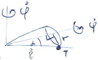
V točki  $T$  ima hitrost:  $\vec{v} = \dot{\varphi} \vec{r} + \dot{\psi} \vec{n} \vec{r} = 0$
