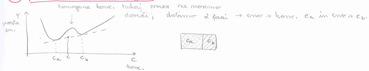
$c_a < c < c_b$ : fazna separacija  $\rightarrow$  sistem se razdeli na 2 fazi
