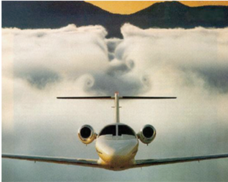
Slika 13: Podkvasti vrtinec za LearJetom nakazuje navpično gibanje zraka za krili aviona.
