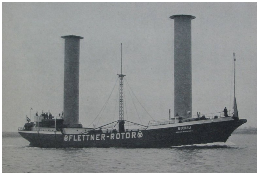
Slika 1: Jadrnica "Buckau" s Flettnerjevima kriloma (okrog l. 1926). Cilinder se je vrtel s frekvenco 100/min. Jadrnica "Baden – Baden" s Flettnerjevim krilom je l. 1926 uspešno preplula Atlantik. Tretja v seriji je bila jadrnica "Barbara".
