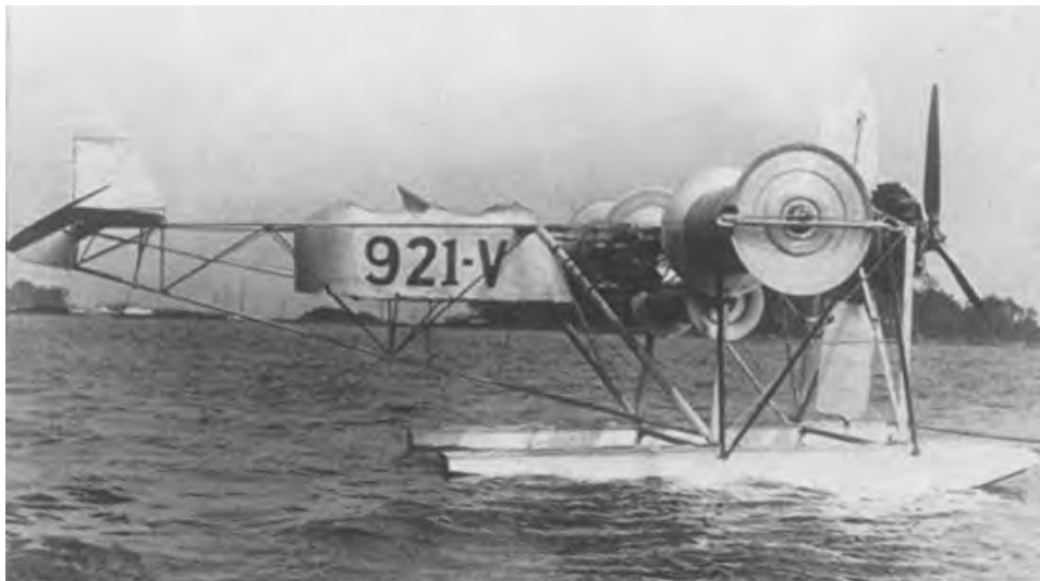
Slika 3: Prototip letala s Flettnerjevimi krili, 921-V, skonstruiran v Ameriki (slika ga prikazuje med testi na reki Hudson) po tem, ko je jadrnica Baden-Baden uspešno preplula Atlantik. 921-V naj bi letel vsaj enkrat predno se je razbil.
