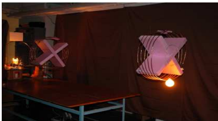
Slika 8: Slika poskusa prenosa energije s pomočjo resonančno sklopljenih tuljav na inštitutu MIT, pri katerem so na 2m prižgali 60W žarnico.
