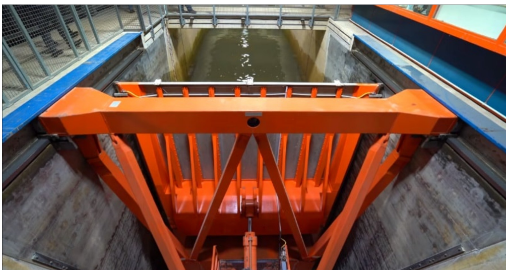
Slika 4 [11]: Naprava in bazen, v katerem lahko ustvarimo razbojniške valove. Nahajata se v Hannoveru.
