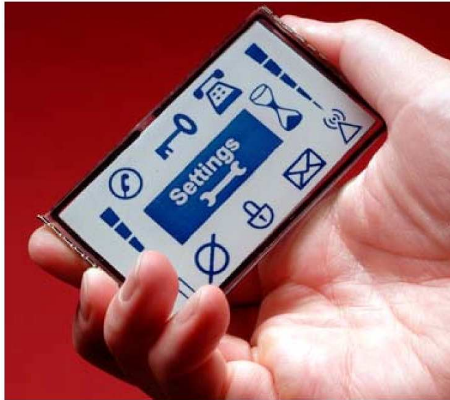
Slika 6: Demonstracijski elektrokromni zaslon. Na sliki vidimo visoko kontrastno razmerje takšnih zaslonov pri ambientni osvetlitvi [9].
