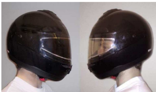
Slika 5: Motoristična čelada z vizirjem s spremenljivo prepustnostjo svetlobe. Na levi strani vidimo povsem obarvan, na desni pa povsem razbarvan vizir [4].
