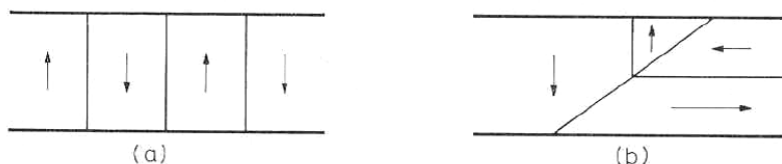
Slika 3 Domene v feroelektriku z eno polarno osjo se raztezajo prek debeline vzorca in oklepajo pravi kot z elektrodami (a). V feroelektriku z dvema osema se domene izognejo naboju površine 90^\circ sten tako, da vklepajo meje z elektrodami kot 45^\circ (b) [5].
