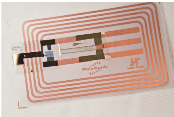
Slika 16: Organska RFID oznaka (levo) z resonančno frekvenco 13.56 MHz in dosegom 10 cm pri jakosti magnetnega polja 1.25 A/m. Oznaka vsebuje 64-bitno kodo, ki jo lahko prenese s hitrostjo 787 bits/s. Vezje, ki je integrirano na oznaki, vsebuje približno 400 organskih tranzistorjev (levo). Takšna vezja so upogljiva in praktična za izdelavo z brizgalnimi tiskalniki. Organske RFID oznake bi naj nadomestile črtne kode [7].
