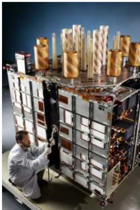
Slika 1: Primer GPS satelita. Na sliki je prikazana velikost satelita v primerjavi s človekom [2].
