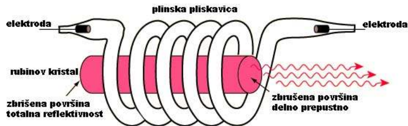
Slika 2: Delovanje rubinovega laserja. Vijolični valj je rubinov kristal, katerega ioni se vzbujajo s pomočjo bliskavice, ki je ovita okoli njega. Ena stran rubina je gladka z reflektivnostjo blizu 100%, druga pa delno prepušča [4].
