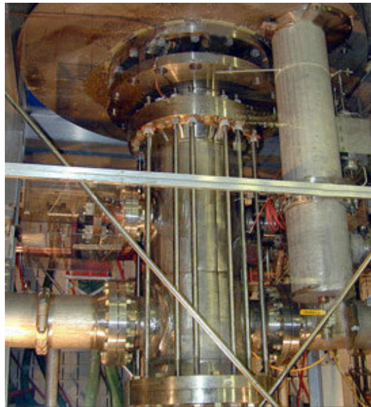
Slika 13. Slika prikazuje Teslov hibridni magnet, ki ima sledeče karakteristike: gostoto magnetnega polja 45 tesla, notranjo odprtino 32 mm, težo 31.750 kg, višino 6,7 metrov, obratuje pri temperaturi -271^{\circ}\text{C} , za obratovanje porabi 33 MW moči in stane okoli 10 milijonov evrov [14].
