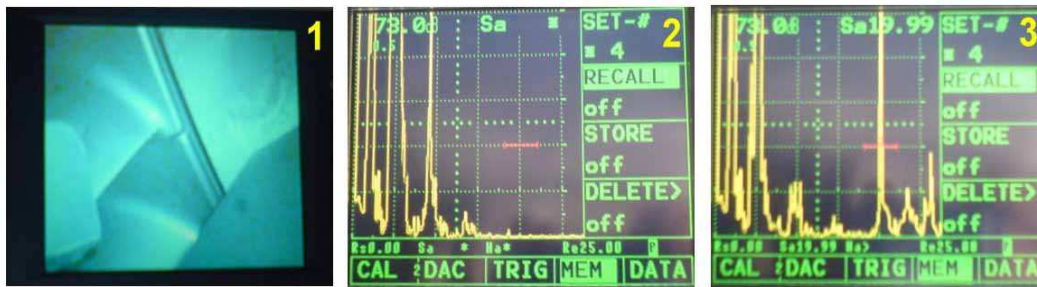
Slika 4: Slika prikazuje izseke testiranja lopatic letalskega motorja, ki so prikazane na podsliki 1. Poslika 2 prikazuje signal brez napake in podslika 3 z napako. Preurejeno iz [2] geslo Ultrasonic testing.
