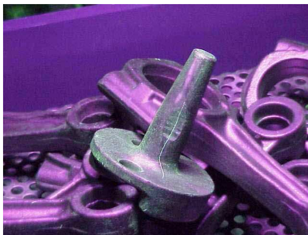
Slika 7: Slika prikazuje avtomobilski del pod UV svetlobo. Svetlo zelena črta je posledica fluorescentnih magnetnih delcev, ki so se nabrali na razpoki.
