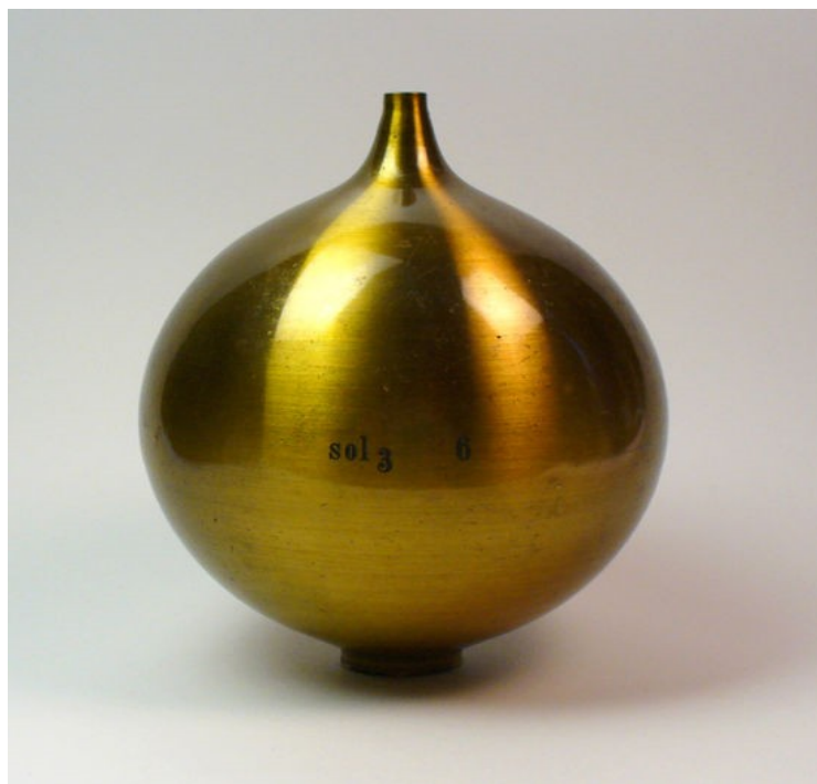
Slika 8: Helmholtzev resonator iz medenine, izdelan po originalni zasnovi Helmholtza [4].
