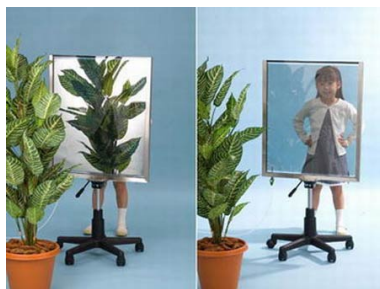
Slika 18: Primer enosmernega zrcala. Ko je stran, kjer je deklica, močnejše osvetljena (desno), vidimo skozi zrcalo. V obratnem primeru (levo), v zrcalu vidimo odsev rože.
