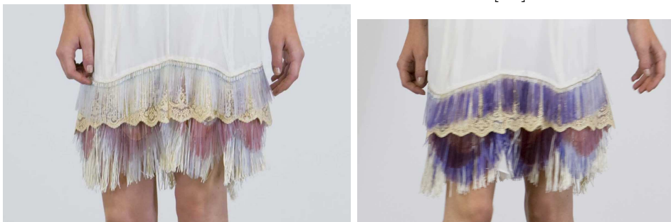
Slika 29: Rob obleke iz tekočerkristalnega elastomera sprememni barvo iz svetle v temno ob spremembi osvetlitve [22].
