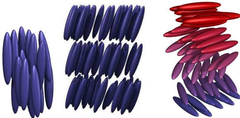
Slika 3: Nematska faza (levo), smektična faza (sredina), kiralno nematska faza (desno) [4].
