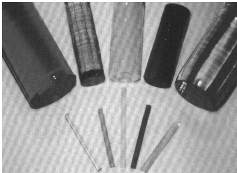
Slika 16: Keramike uporabljamo tudi v laserskih sistemih kot izvor laserske svetlobe. Na sliki monokristali in izrezane palčke za uporabo v laserjih. [5].
