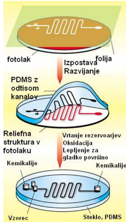
Slika 13: Izdelava mikrofluidične naprave iz PDMS[2]. Na folijo natisnejo kanale mikrofluidične naprave. Nato s fotolitografijo izdelajo kalup. V kalup vlijejo PDMS, izvrtajo rezervoarje za kemikalije, na koncu prilepijo izdelano strukturo na kos stekla.
