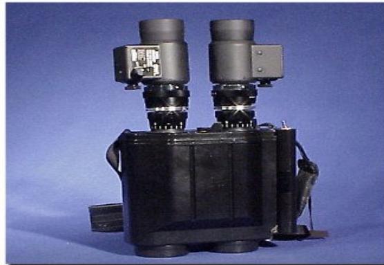
Slika 22: primer očal - ojačevalnika slike, ki ga v vojaške namene proizvaja B.E. Meyers podjetje [12].
