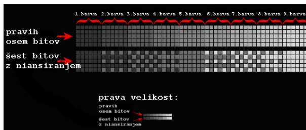
Slika 27: Prostorsko niansiranje. Vsak kvadrateg predstavlja povečano slikovno točko zaslona TFT. Kontrast na sliki je namenoma pretiran za lažje razumevanje. V resnici sta si sosednja odtenka sive precej bolj podobna in vzorce mnogo težje opazimo. [4]
