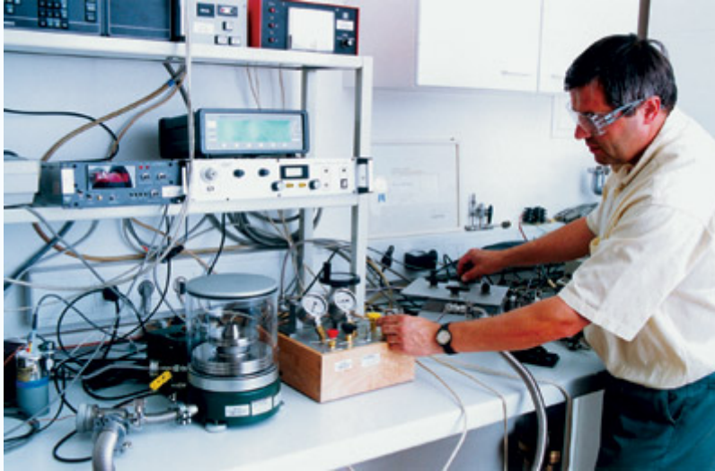
Slika 19: Naprave za vzdrževanje reference tlaka: 2 tlačni tehtnici, Kvarčni Bourdonov manometer, Kapacitivni membranski vakuummeter, Viskoznostni vakuummeter z lebdečo kroglico. Vir: [15].
