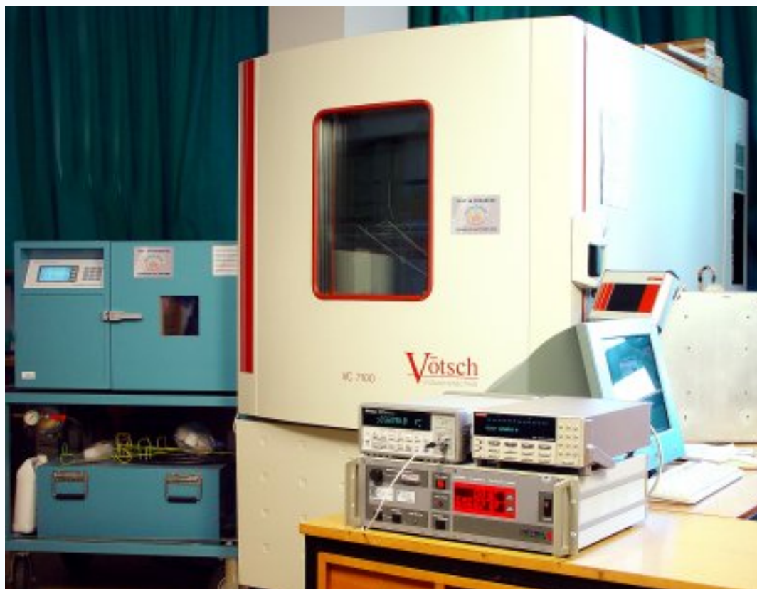
Slika 16: Naprava za vzdrževanje reference vlage. Vir: [11].
