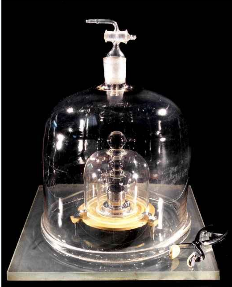
Slika 2: Prakilogram iz Sèvresa. Vir: [2].
