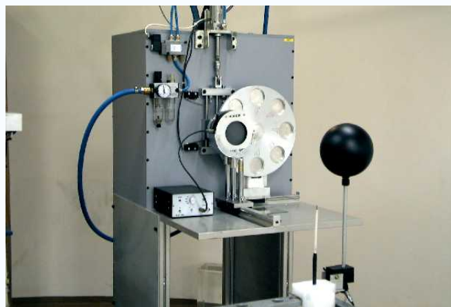
Slika 18: Naprava za merjenje sevanja z referenčnimi ionizacijskimi celicami in elektrometri. Vir: [14].
