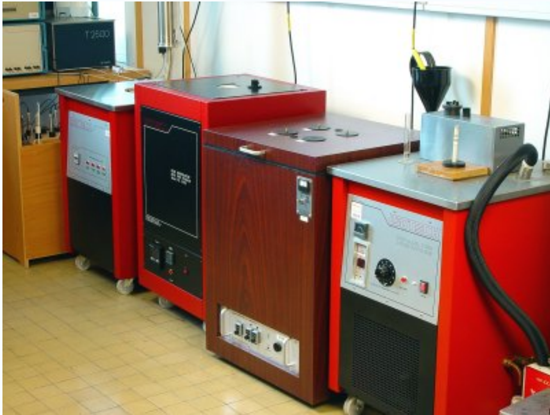
Slika 8: Aparature za vzdrževanje reference temperature. Vir: [10]
