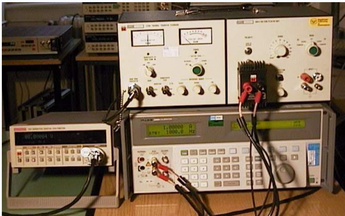
Slika 12: Aparature za vzdrževanje reference izmeničnega toka. Vir: [11].
