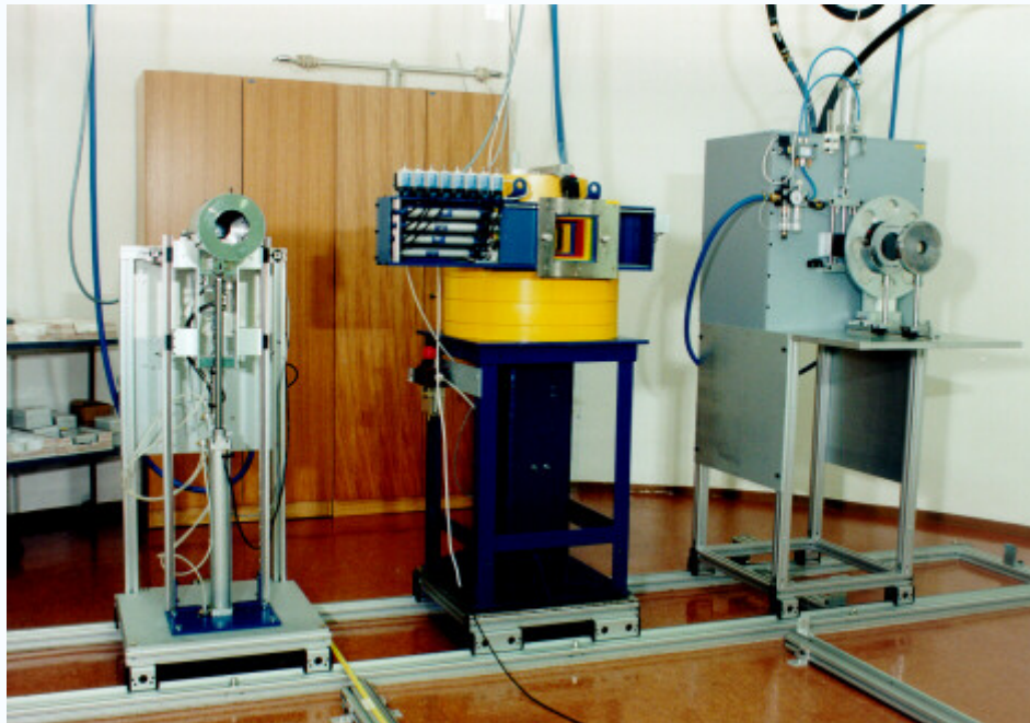
Slika 17: Naprave za vzdrževanje referenčnega izvora sevanja z ^{60}\text{Co} , ^{137}\text{Cs} , ^{241}\text{Am} in 160 kV katodno cevjo. Vir: [14].
