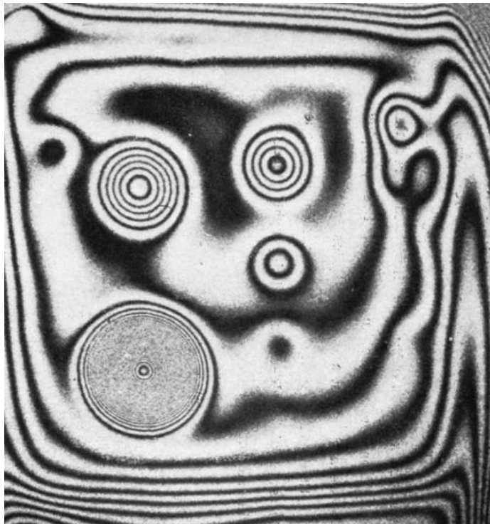
Slika 13: Krožne proge na tej sliki aluminijaste plošče nakazujejo, kje je ta po eksperimentu z vakuumom odstopila od gumijaste, s katero sta bili zlepljeni [8].
